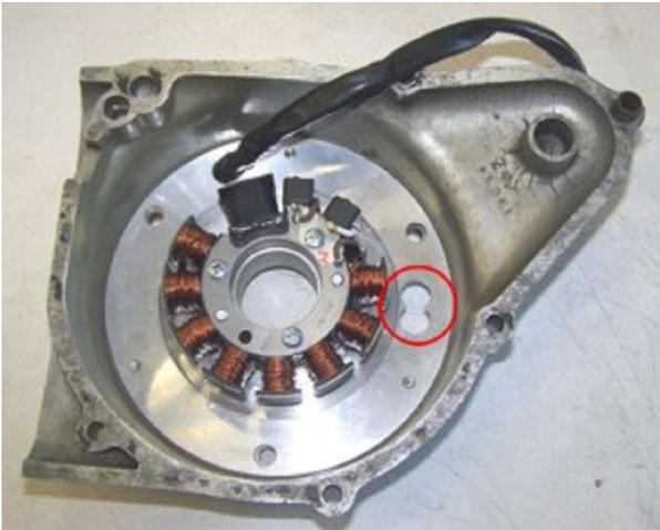
Setzen Sie die Grundplatte mit dem Stator in den Motorgehäusedeckel. Die beiden Löcher (im Bild rot eingekreist) sollten dabei auf ca. 3 Uhr liegen.
