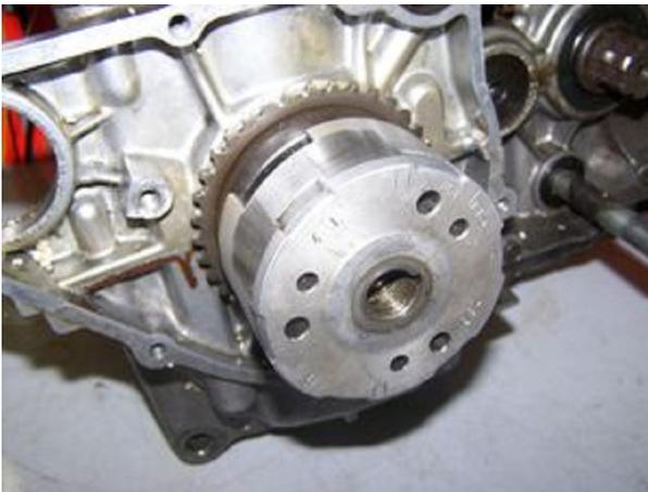
Jetzt können Sie den alten Rotor und Stator ausbauen. Entfernen Sie auch die Passfeder von der Kurbelwelle, sonst können Sie den neuen Rotor später nicht aufsetzen.
