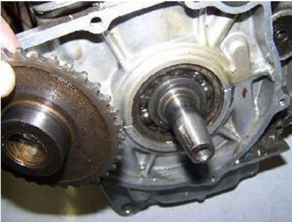
Entfernen Sie das Antriebsrad und die Kette des elektrischen Starters.
