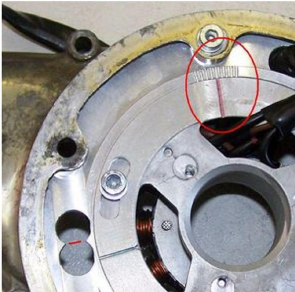
Setzen Sie den Gehäusedeckel mit dem eingebauten Stator wieder auf den Motor.
