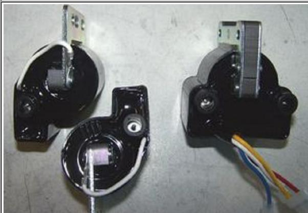
Alternativ bieten wir 2 Einzelspulen an, die parallel betrieben werden. Mit einer solchen Anordnung ist es möglich jeweils nur einen Zylinder zu testen. Die andere Spule wird einfach abgeklemmt.
