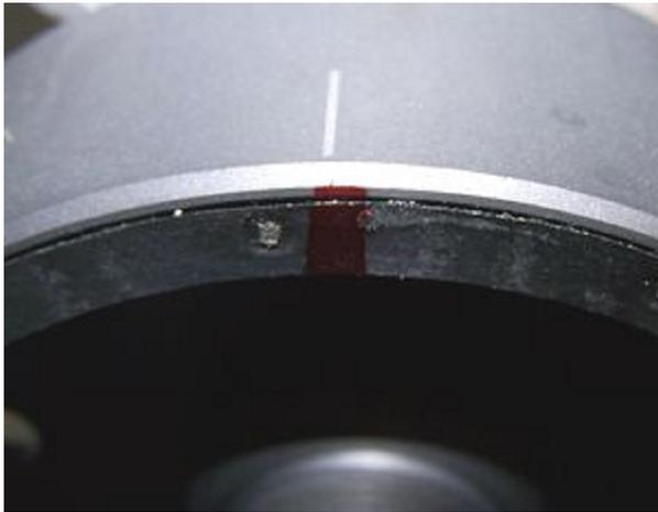
Auf dem Umfang des Rotors ist eine Lasermarkierung. Diese sollten Sie (z.B. mit einem Filzstift) wie im Bild gezeigt auf die Kunststoffummantelung der Magnete verlängern.
