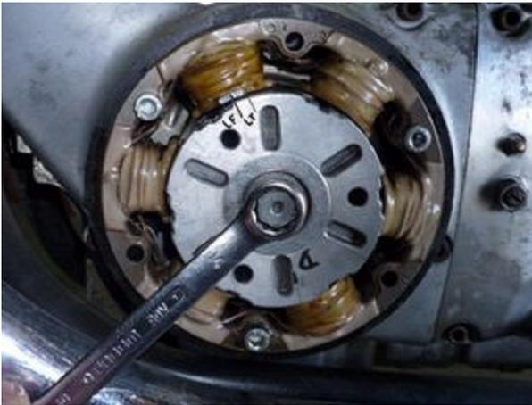
Bevor Sie die alte Anlage ausbauen, stellen Sie den linken Zylinder auf OT (oberer Totpunkt). Das ist die "T" oder "LT" Markierung auf dem alten Rotor.
