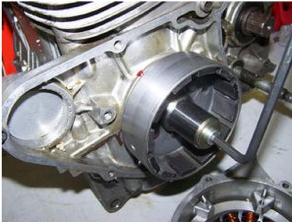
Schrauben Sie die Zündkerzen heraus (damit Sie den Motor leichter drehen können) und bringen Sie den linken Kolben in OT Stellung.
