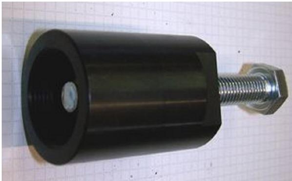
Um den neuen Rotor abzuziehen nutzen Sie bitte nur den beiliegenden Abzieher M27x1,25.
